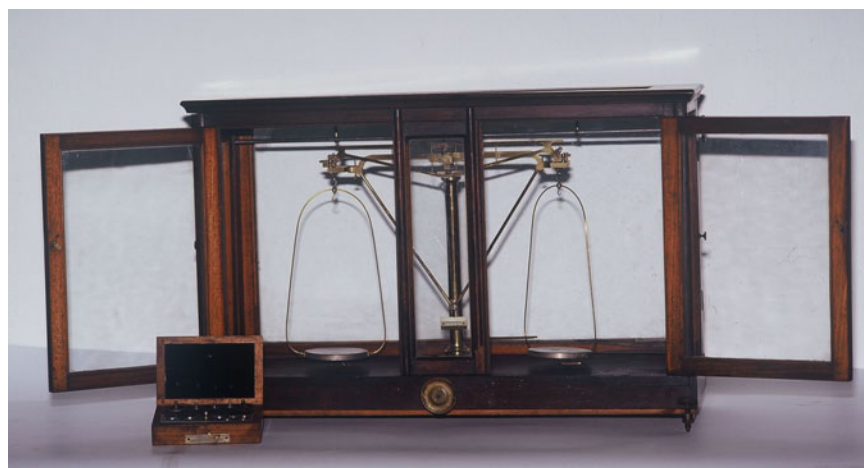
Sl. 10. Najstarejša ohranjena analitska tehtnica na Jesenicah, ki nosi letnico 1897. (Fotoarhiv GMJ)
